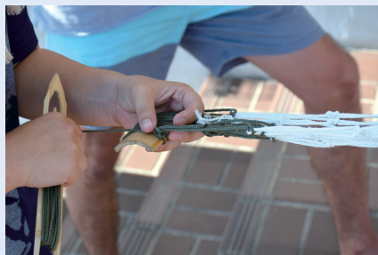
コマに編み目をひっかけて引っ張りながら、網針で糸を編み込んでいく
